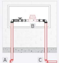
• Observe no medidor a seta que aponta qual deve ser o sentido do fluxo da água, saiba que a instalação deve seguir esta orientação.
